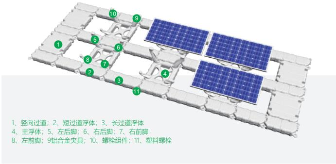
MRac水上漂浮式系统G4N 适用于水面安装，材料采用高密度聚乙烯 (HDPE)材料，符合Hunt吸水试验(CN)、抗老化、抗紫外线等测试标准，可承受拉力远超国内外同类产品。浮筒和主浮体采用了新型模块化设计，实现同向双排或对称双排等排布方式，提升装机量与发电量，安装简易、方便，并降低了项目成本，使用寿命长达25年。
